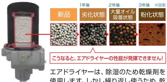
エアドライヤーは、除湿のため乾燥剤を使用します。しかし繰り返し使うため、乾燥剤は次第に劣化していきます。
